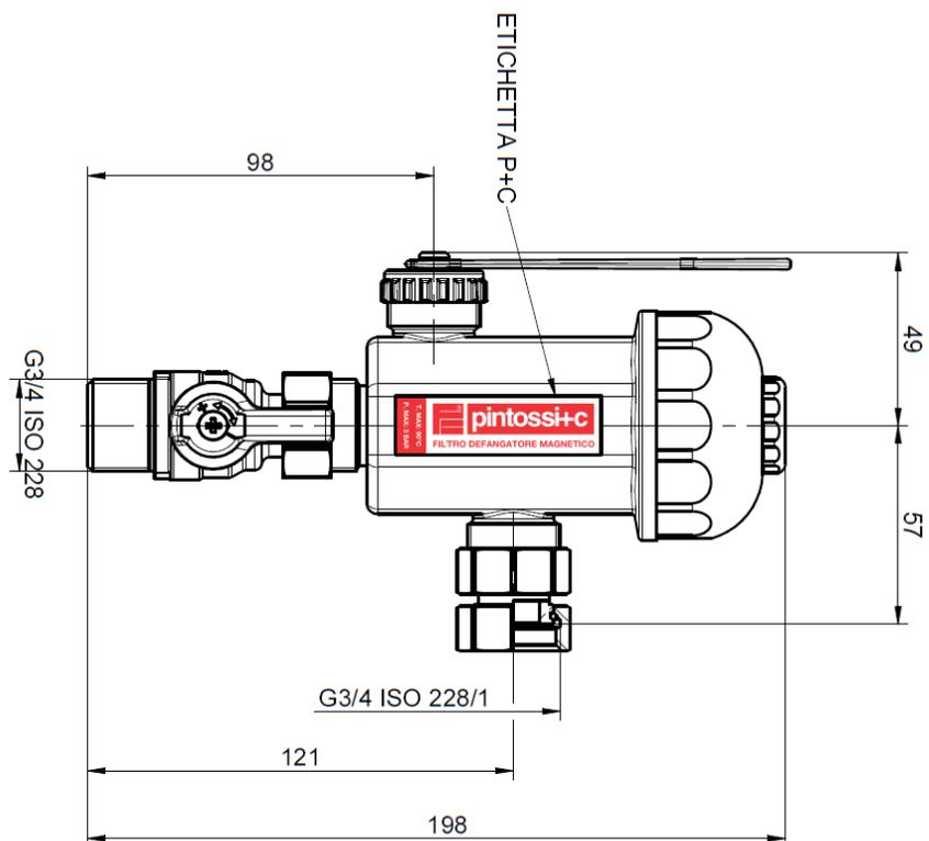
**Installazione** È consigliato installare il filtro sul circuito di ritorno, in ingresso alla caldaia. Il filtro ha tre fori filettati G 3/4" che permettono di installarlo sia in posizione verticale che orizzontale, in modo tale da adattare l'installazione in base alle specifiche dimensioni e spazi dell'impianto.
